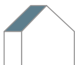
TOIT À DEUX VERSANTS
